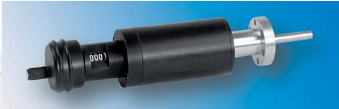
UHV-Drehdurchführungen mit Handrad und 4-stelligem Positions-zähler, Motoranflanschung alternativ
